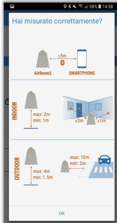
Figura 22 – Schermate app: tecnica di misurazione suggerita per il particolato atmosferico mediante dispositivo AirBeam2
