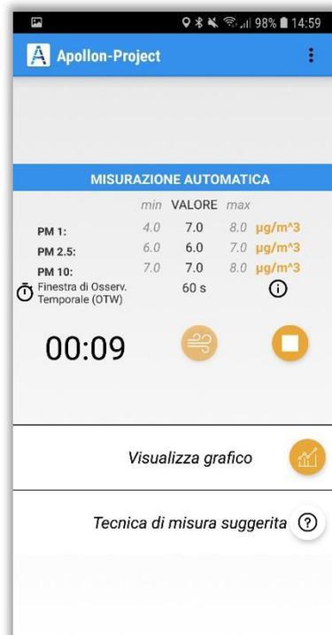
Figura 19 – Schermate app: indicatori numerici per il monitoraggio strumentale del particolato atmosferico
